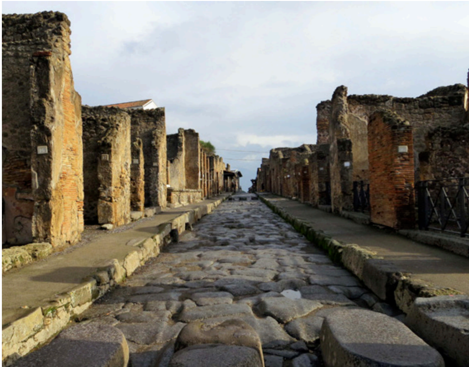
De ruïnes van Pompeï. Het organisatieprincipe van een straat met rijbaan en trottoirs blijft na honderden jaren nog steeds goed zichtbaar. De stapstenen op de voorgrond werden gebruikt om de rijbaan goed over te kunnen steken, bijv. als die erg nat was door regenval of vies door afval, uitwerpselen van dieren etc.
